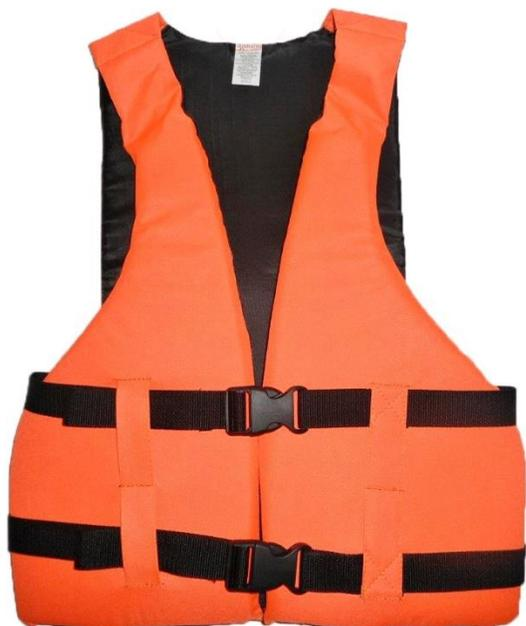
Chaleco salvavidas con relleno en polietileno expandido, tela reebag 100% impermeable, correas de ajuste de 1" en poliamida 100%, hilos en poliamida, chapas en acetel, color naranja, capacidad de flotabilidad de minimo 115 kg. Cinta reflectiva en la parte superior.
