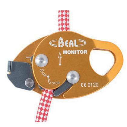
Anticaídas deslizante en aluminio accionado mediante leva, con placa lateral oscilante que minimiza la abrasión de la cuerda.
