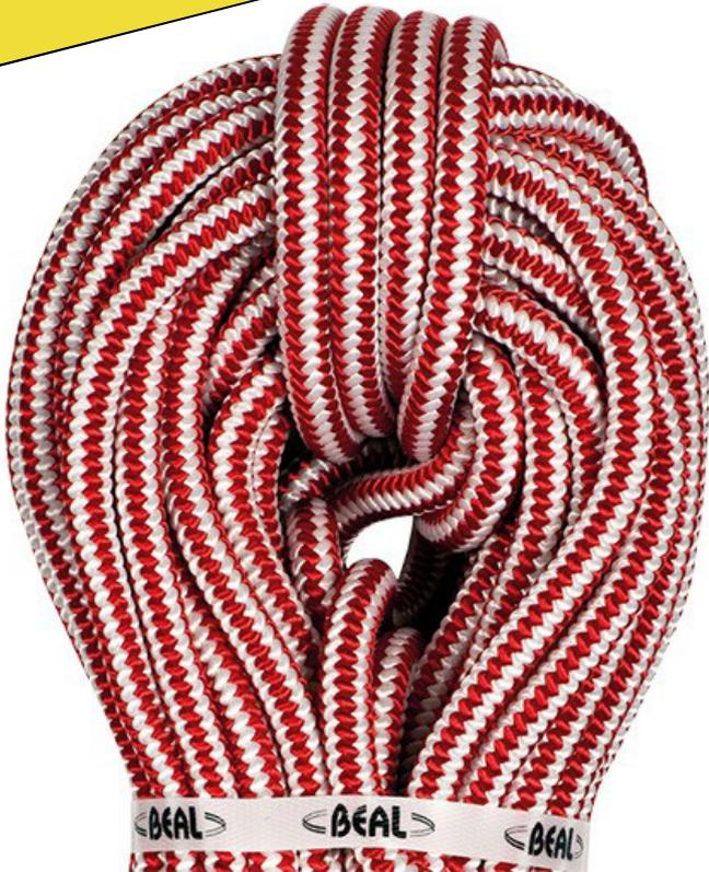
Su trenzado, fruto de la tecnología de fabricación de las cuerdas de poda norteamericanas, le proporciona unas magníficas cualidades de resistencia, flexibilidad y facilidad de manejo. El proceso UNICORE, que une el alma y la funda, previene el deslizamiento de la funda cuando se utiliza con un nudo autobloqueante.
